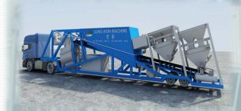
고정식 플랜트의 중요 생산 시스템을 적용한 이동식 배쳐 플랜트 SW-M2 series 와 함께 하십시요
