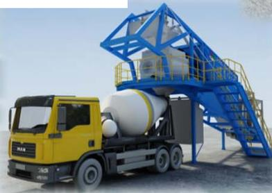
고정식 플랜트의 중요 생산 시스템을 적용한 이동식 배치 플랜트
