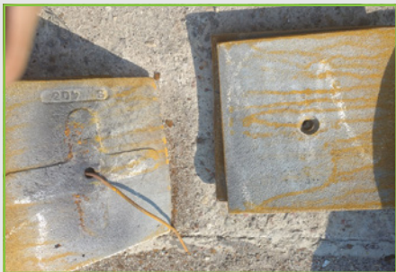
텡스텐 분말을 이용한 라이너 제작
